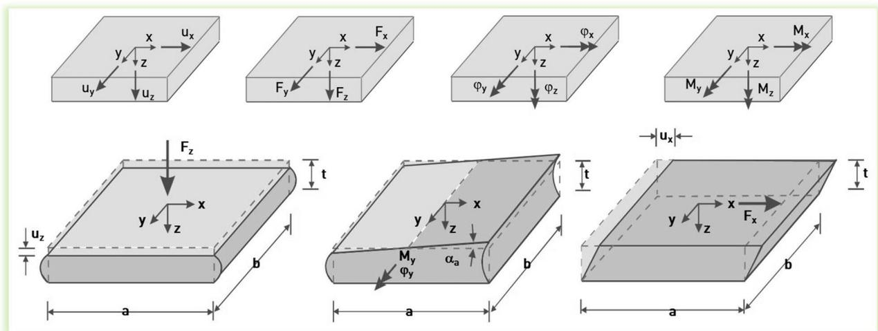
Abbildung 1 Definition des Koordinatensystems, der Lagerverschiebungen, der Lagerkräfte, Lagerverdrehungen und Lagermomente
