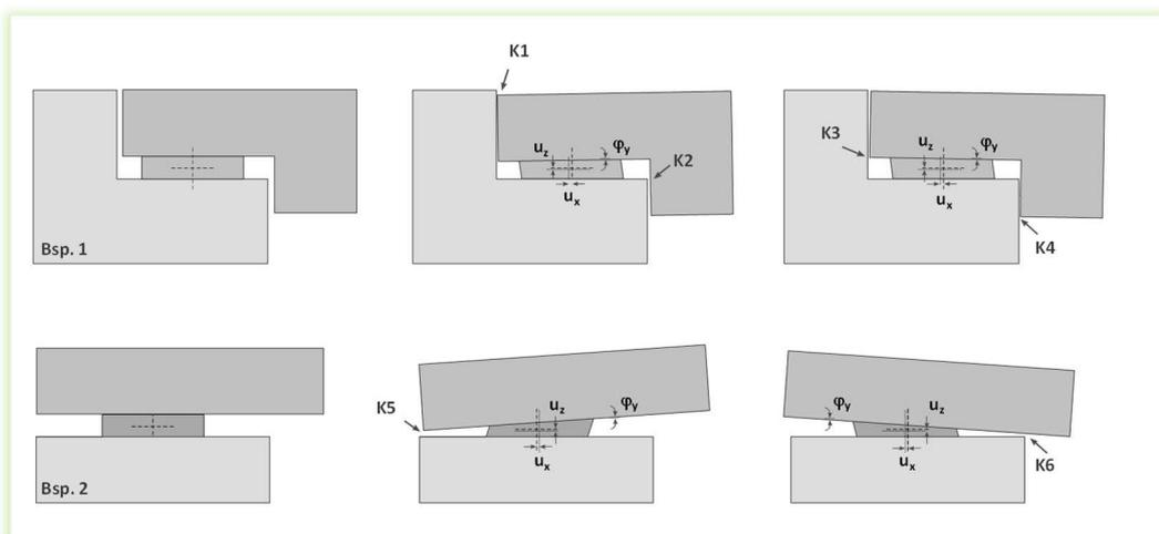
Abbildung 3 maßgebliche Stellen einer Kollisionsprüfung
