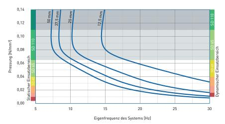
Eigenfrequenz eines Systems, bestehend aus einer kompakten Masse und einer elastischen Lagerung aus SPEBA® vibrafoam 65 auf starrem Untergrund.
