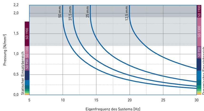
Eigenfrequenz eines Systems, bestehend aus einer kompakten Masse und einer elastischen Lagerung aus SPEBA® vibrafoam 1300 auf starrem Untergrund.
