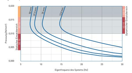
Eigenfrequenz eines Systems, bestehend aus einer kompakten Masse und einer elastischen Lagerung aus SPEBA® vibrafoam 10 auf starrem Untergrund.
