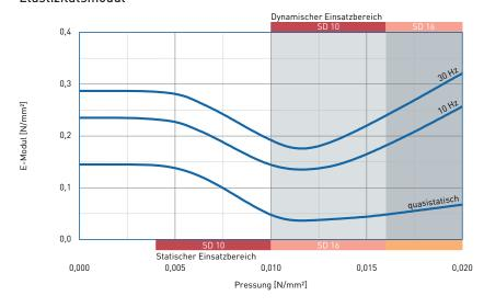
Dynamische Prüfung: harmonische Anregung mit einer Amplitude von  $\pm$  0,22 mm bei 10 Hz und  $\pm$  0,08 mm bei 30 Hz
