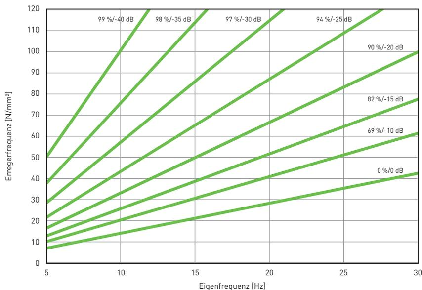
Dargestellt ist die Isolierwirkung für einen Ein-Massen-Schwinger auf starrem Untergrund mit SPEBA® vibra hard. Parameter: Kraftübertragungsmass in dB, Isolierwirkungsgrad in %.
