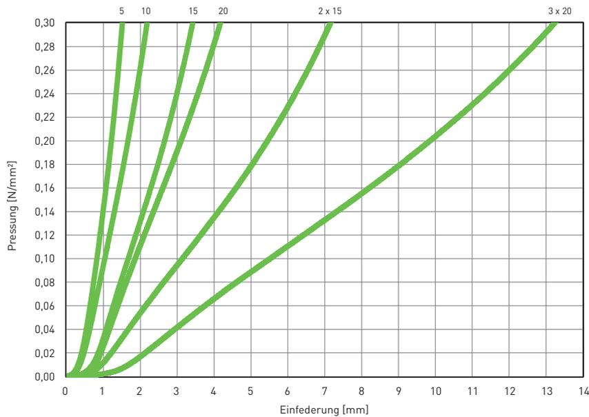
Aufgezeichnet wurde jeweils die 3. Belastung, Prüfung bei Raumtemperatur zwischen ebenen Stahlplatten.
