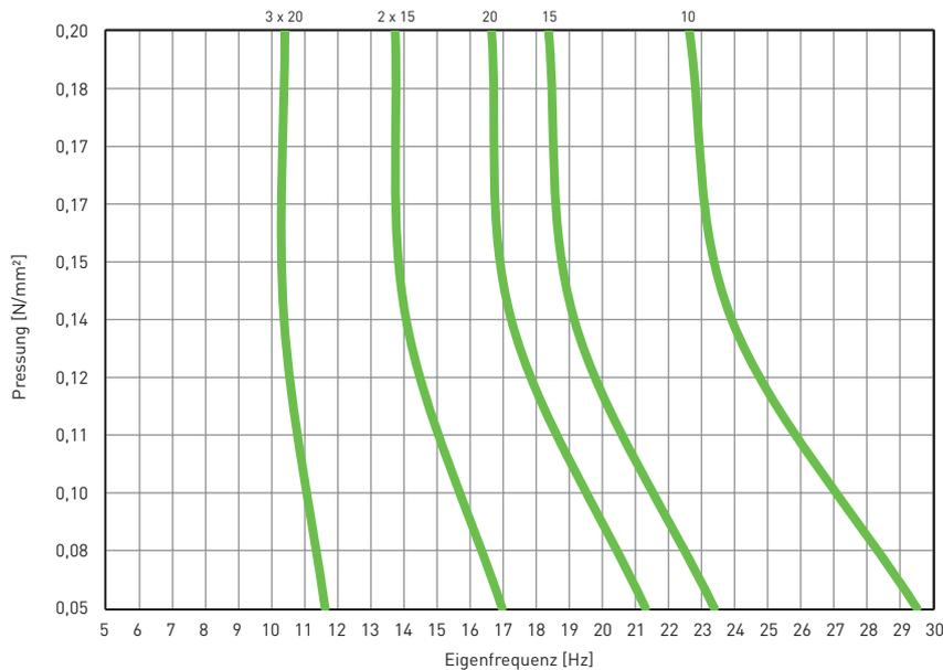
Eigenfrequenz des Systems bestehend aus einer kompakten Masse und einer elastischen Lagerung aus SPEBA® vibra hard auf starrem Untergrund
