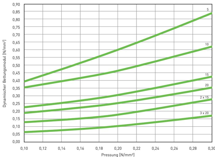
Dynamische Prüfung: harmonische Anregung mit einer Amplitude von  $\pm 0,25 \text{ mm}$  bei  $10 \text{ Hz}$
