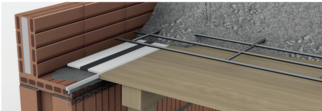
Die Auflagerfläche auf dem Mauerkopf ist sauber und eben abzureiben und von Fett und körnigem Material zu säubern. Um die Bewegungsfreiheit zu gewährleisten, sollte die Unterkante der fertigen Decke gleich der Oberkante des Lagers sein.
